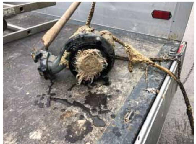
Schwere Schäden durch Abfallentsorgung über das Kanalnetz. Foto: privat, WAV)
